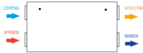
Widok od strony klapy inspekcyjnej.
